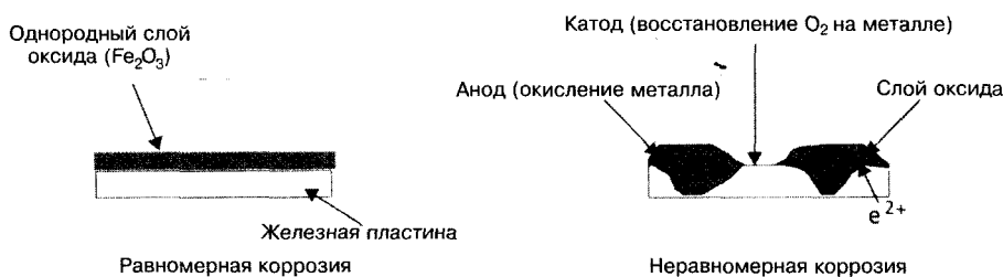
Рис. 12.1. Два вида влажной коррозии
